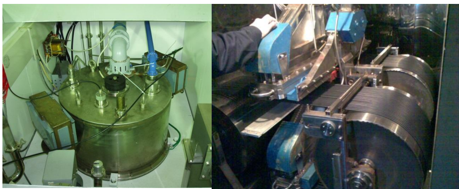
Рисунок 3. Ускоритель ИЛУ-8 внутри местной защиты на линии по обработке проводов
