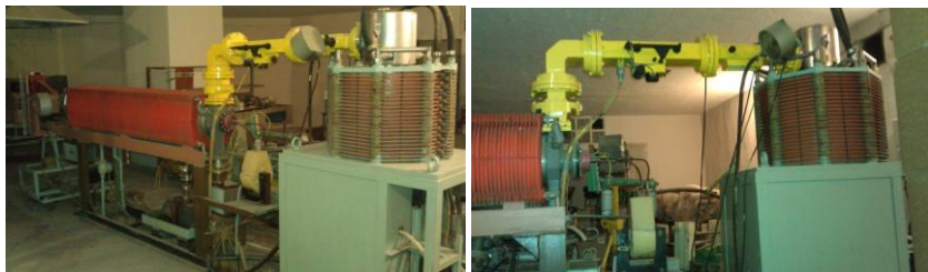
Рисунок 1. Ускоритель с энергией электронов 10 МэВ и мощностью в пучке 15 кВт.
