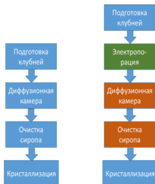
Рисунок 2. Технологическая схема экстракции сиропа из сахарной свеклы
